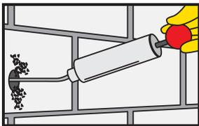
El orificio de perforación debe limpiarse con una bomba de soplado o con aire comprimido, comenzando desde la parte inferior del orificio (al menos x 2 ).
