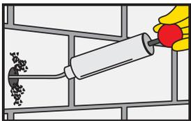
El agujero de perforación debe limpiarse con una bomba de soplado o con aire comprimido, comenzando desde la parte inferior del agujero. (al menos x 2 )
