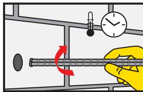
Insertar el ancla con un ligero movimiento de rotación en la perforación rellena con adhesivo. Un poco de adhesivo debe salir de la perforación como excedente. El ancla debe siempre ser colocada durante el tiempo de gelado del material.
