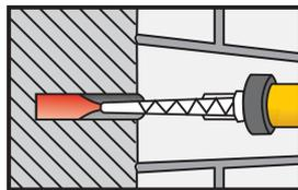
Inyecte el adhesivo en el orificio, comenzando desde la parte inferior, mientras retira lentamente la mezcladora estática. En cualquier caso, evite atrapar aire. Para agujeros profundos se puede utilizar tubo de extensión.
